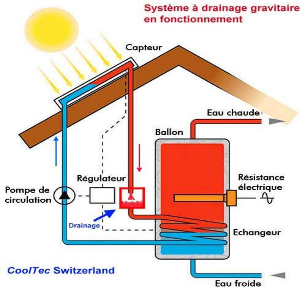
En fonctionnement l'air initialement dans les capteurs circule jusqu'à un ballon de drainage dans lequel il est retenu tant que la pompe de circulation fonctionne.
