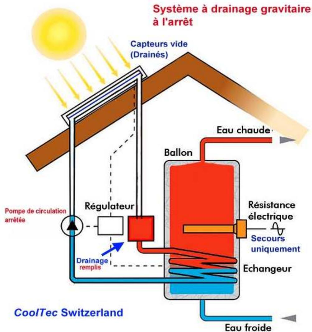
Pas de liquide dans les capteurs = pas de surchauffe = pas de surpression
